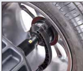
ディスタンス、径自動入力(ウェイト貼付修正時は全自動入力です)
